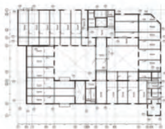
臺南安平案，原 RC 造的結構設計需用 25 公分厚的承重牆，改成 CLT 木構造後，結構計算牆厚只需 14 公分。(圖片來源：rjc 結構公司)
